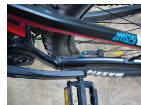
Kabel v místě, kdy by mohlo dojít k jeho poškození, z rámu vyčnívá v nejmenší možné míře.
